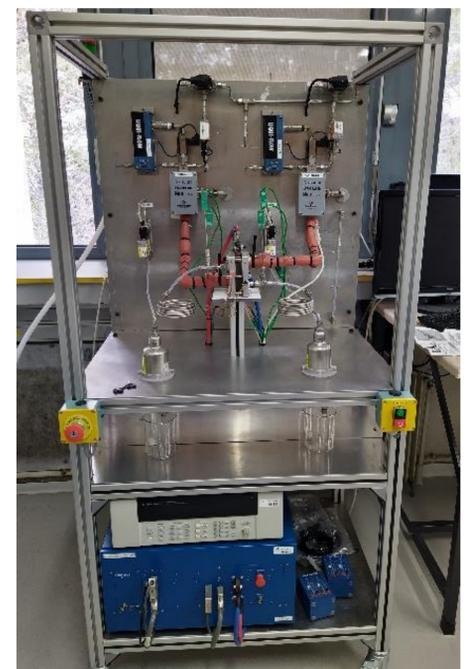
Le banc mono-cellule pile à combustible PEM.
